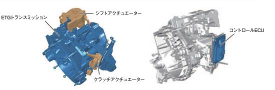
ETG 5では、TCUとアクチュエーターを新開発し、多機能と高効率、高燃費を実現しています。無鉛化されたTCUには新たなクラッチアクチュエーターを装備し、さらに高度なシステムコントロールを行います。アクチュエーターは小型化され、高効率の小型モーターを搭載。ギアボックスに固定し、コネクターなどを見直すことによってコンパクトに仕上げ、ダイレクトでスムーズなギアチェンジを実現しています。
