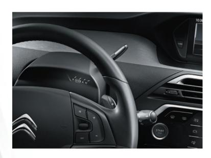
ETG 5 (Efficient Tronic Gearbox 5:エフィシャント・トロニック・ギアボックス 5) は、PSAプジョー・シトロエン・グループが新たに開発、製造する次世代型のトランスミッションです。オートマチックモードと、パドルシフトによるマニュアルモードによってリニアなレスポンスとダイレクトな走行感覚を生み出します。また、スムーズなギアシフトプログラムと操作性に優れたクリープ機構など扱いやすい機能も持ち合わせています。
