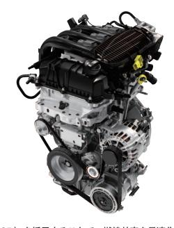
の点火調整(IGR)を採用することで、燃焼効率を最適化しました。アルミ ニウム合金製のシリンダーヘッドには、気筒あたり4本のバルブを配置し、 マルチポイント方式およびインテーク/エキゾーストの両側に無段階可変バ ルブタイミング(VVT)を採用し、高効率化を図っています。
